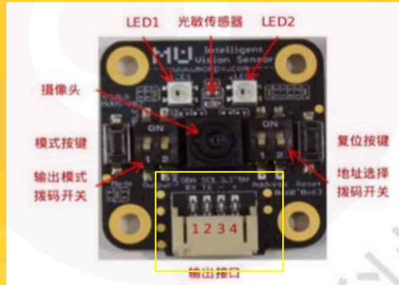
模块左侧输出模式拨码开关1拨至下方, 2拨至上方
